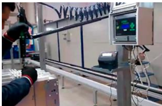
Prozess unter Kontrolle und Ausdruck der Schraubergebnisse
