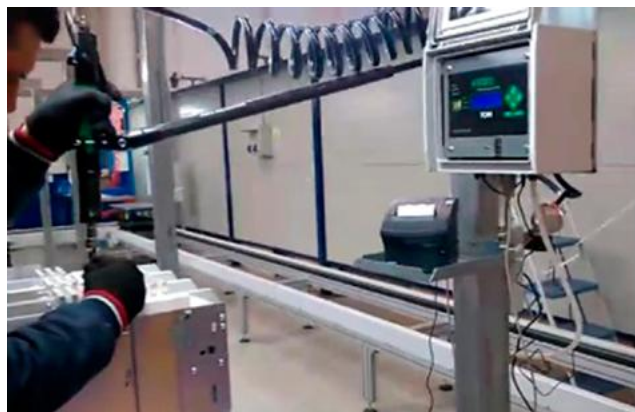
Prozess unter Kontrolle und Ausdruck der Schraubergebnisse
